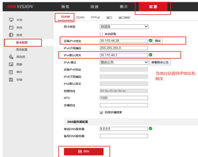
图 47 修改摄像机 IP 地址、子网掩码、网关
