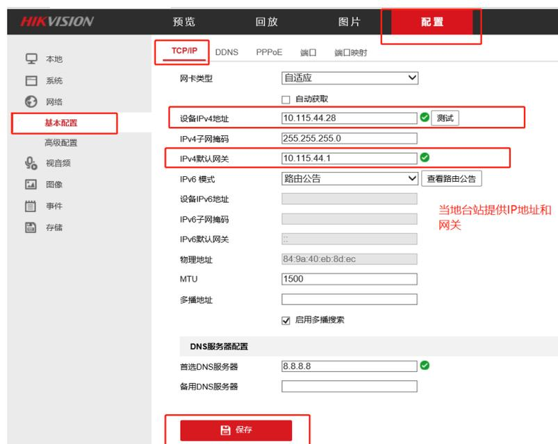
图 59 修改摄像机 IP 地址、子网掩码、网关
