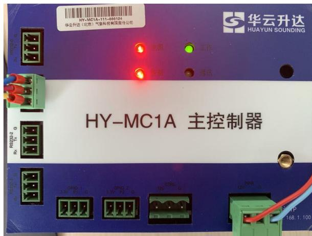
图 91 调试主控串口实物示意图
