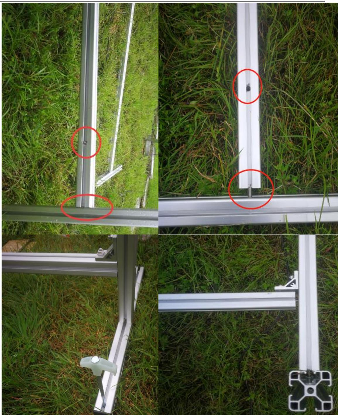
图 29 电线支架拼装方式示意图
