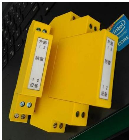
图 10 串口防雷器实物图
