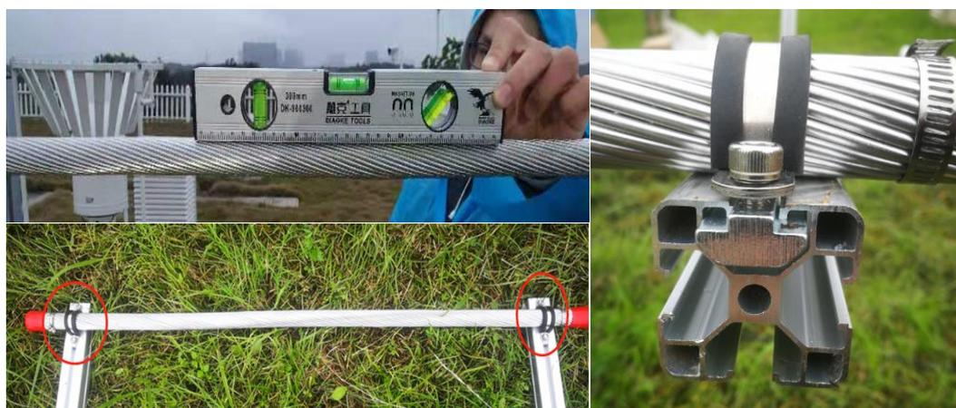
图 28 积冰电线组装细节示意图
