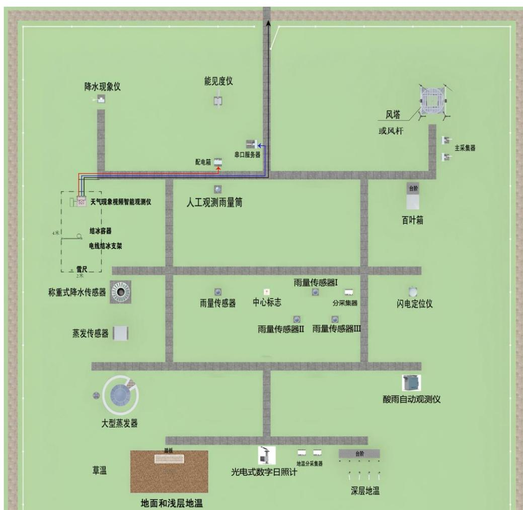
图 23 天气现象视频智能观测仪在观测场中线路连接图-a
