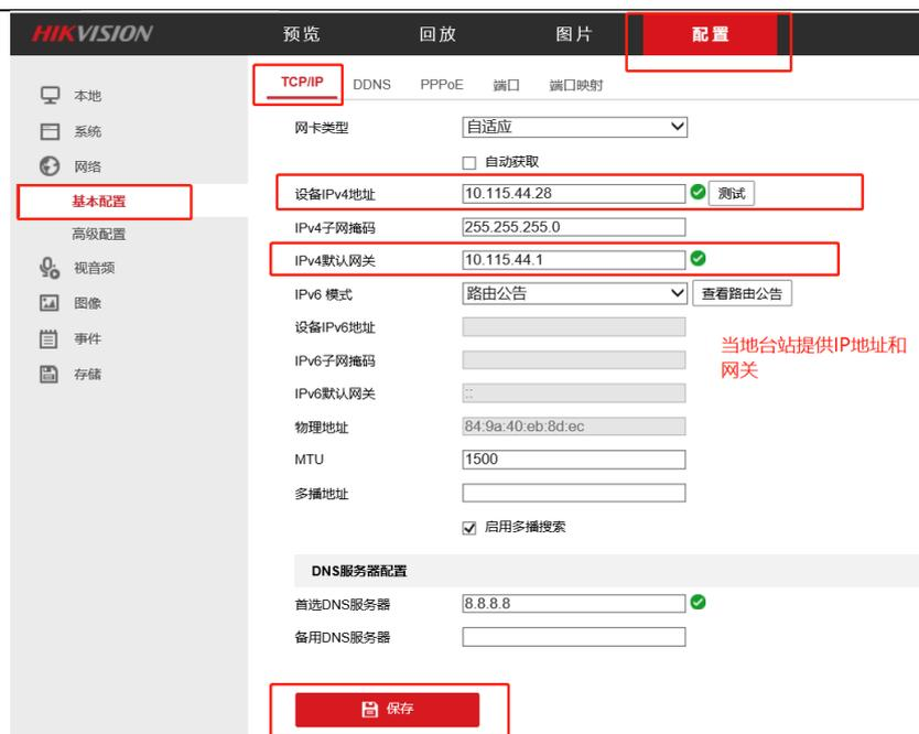
图 72 修改摄像机 IP 地址、子网掩码、网关
